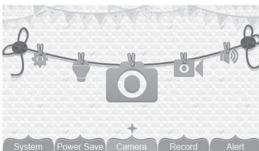
Это меню позволяет присоединить к монитору до четырех камер одновременно и, далее, выбирать для просмотра изображение с любой присоединенной камеры. Второй пункт в этом меню позволяет отключить изображение с присоединенных к монитору камер, но питание на камерах при этом не отключается.
