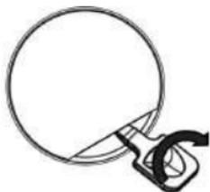
4. Установите батарею (модель: CR2032) в батарейный отсек таким образом, чтобы положительный полюс (+) был обращен вверх.
